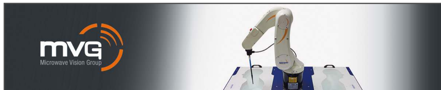
Equipo medidor de SAR (30 a 6000MHz) con doble fantoma
