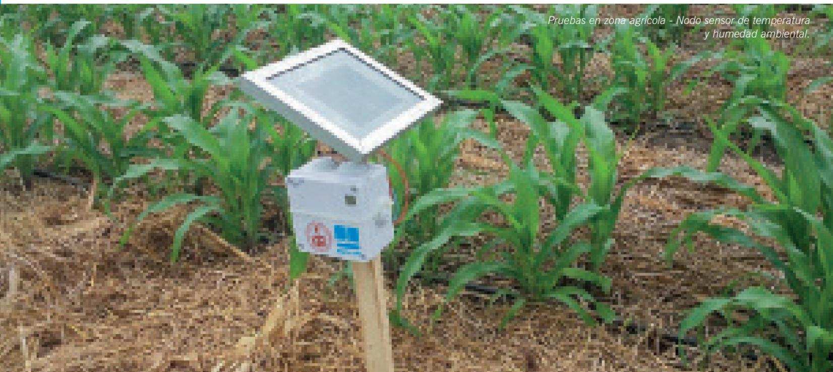
Pruebas en zona agrícola - Nodo sensor de temperatura y humedad ambiental.
