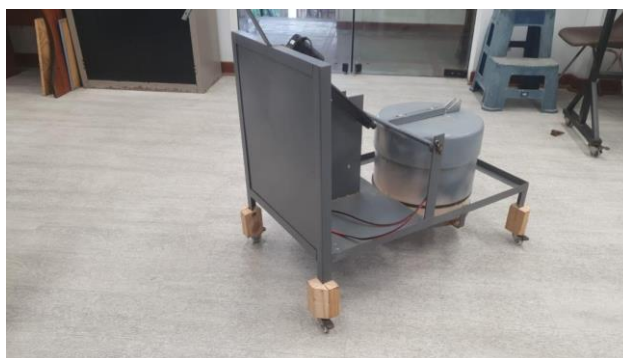
Se insertaron deslizadores a la estructura mecánica
